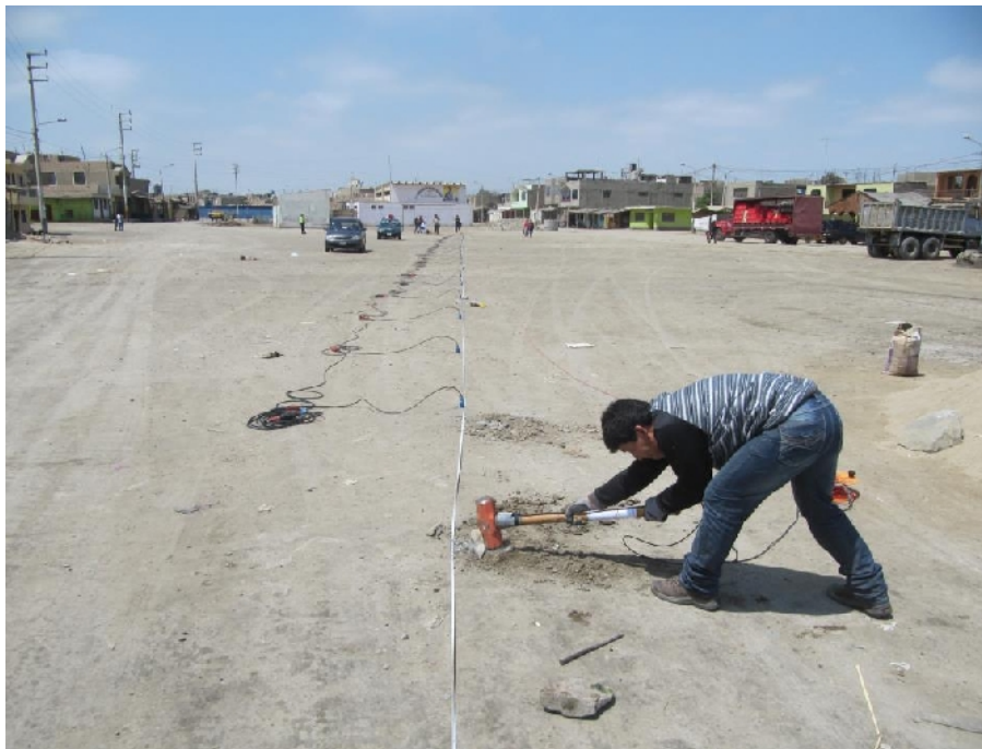
Figura 12: Imagen de la disposición del equipo de refracción sísmica en la ciudad de Chimbote
