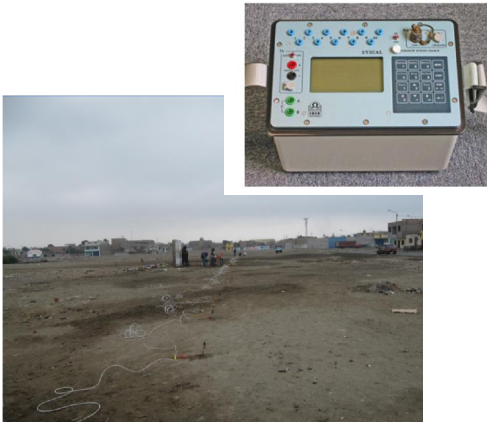
Figura 13: Imagen de disposición del equipo de prospección eléctrica para la toma de datos
