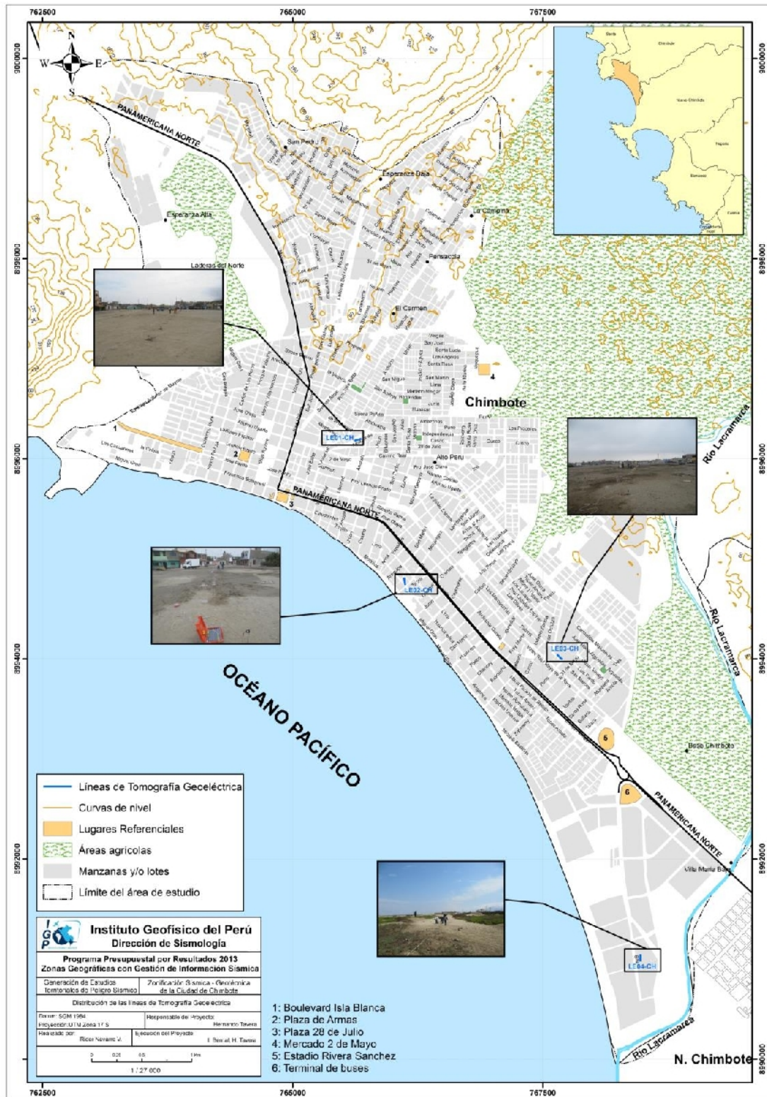
Figura 73: Mapa de la ciudad de Chimbote y ubicación de las 4 líneas de tomografía eléctrica: LE01-CH, LE02-CH, LE03-CH y LE04-CH.
