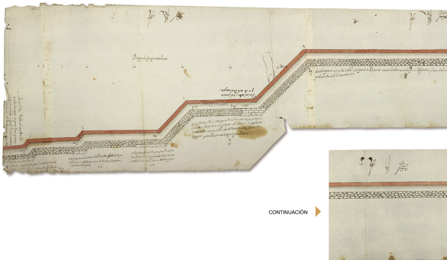
Perfil longitudinal de la alcantarilla de los Caños del Peral entre los Caños del Peral y el Parque de Palacio -Campo del Moro- (1636). A.V.M., Secretaría, 1-85-63
