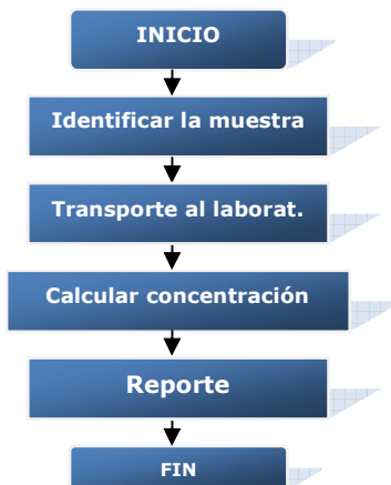
Figura 9. Pasos a realizar después de la toma de la muestra de SO 2 y NO x
