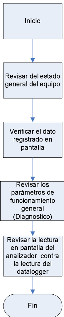
Figura 26. Proceso de revisión del analizador de ozono (O 3 )
