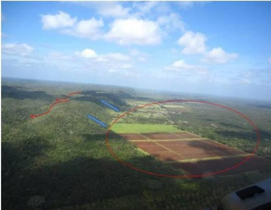
**Fotografía 129.** Zona de acumulación de material edáfico, debido al grado de pendiente y escurrimientos, lo cual fomenta la erosión hídrica laminar en grado alto Eh3, Municipio de Tekax.
