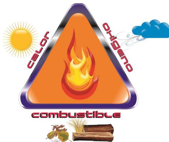
Figura 391. Triángulo del fuego.
