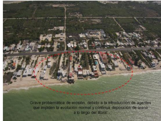
**Fotografía 144.** En la localidad de Yucalpetén, existen construcciones que se encuentran prácticamente dentro del mar debido al desequilibrio sedimentario que existe cuando se construyen diques o espigones.
