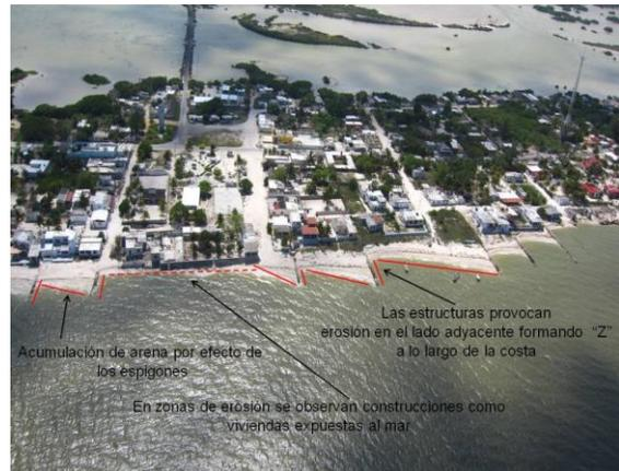
**Fotografía 138.** En la localidad de Chabihau, municipio de Yobain, los diques que acumulan y a la vez erosionan la costa formando estructuras en "Z".
