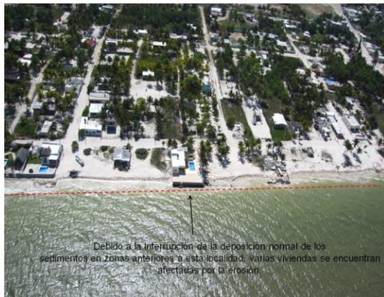
**Fotografía 139.** En el Municipio de Sinanché, los diques construidos en el tramo anterior a esta población, erosionan de manera severa la playa, dejando varias construcciones expuestas frente al mar.
