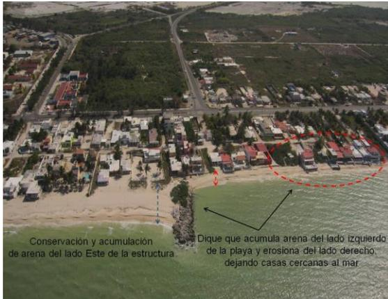
**Fotografía 143.** En la localidad de Yucalpetén, claro ejemplo de acreción-erosión debido a la construcción del dique.
