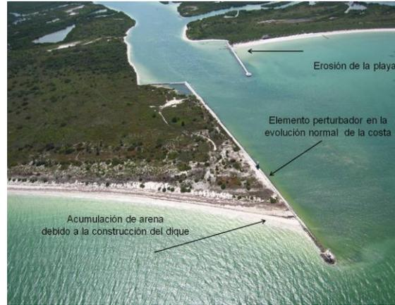
**Fotografía 134.** En la localidad de San Felipe, se aprecia que la corriente lleva una dirección preferente al Noroeste (NW), por lo que los sedimentos se acumulan en la parte izquierda del dique.
