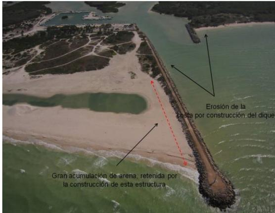
**Fotografía 147.** En Chuburná municipio de Progreso, la acumulación de arena debido a la construcción del dique, provoca también erosión en el lado opuesto.
