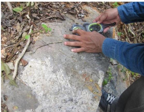
**Fotografía 60.** Talud del punto YPRM22, la brújula indica el buzamiento de la estratificación. Obsérvese que los estratos buzan 12 grados con respecto a la horizontal.
