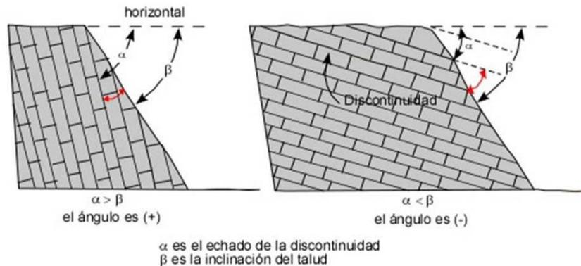
**Figura 70.** Relación entre el echado de las discontinuidades y la inclinación de la ladera.
