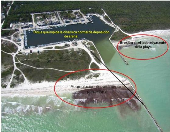
**Fotografía 133.** En la localidad El Cuyo, la construcción de un dique impide la deposición normal de sedimentos a lo largo de la costa.
