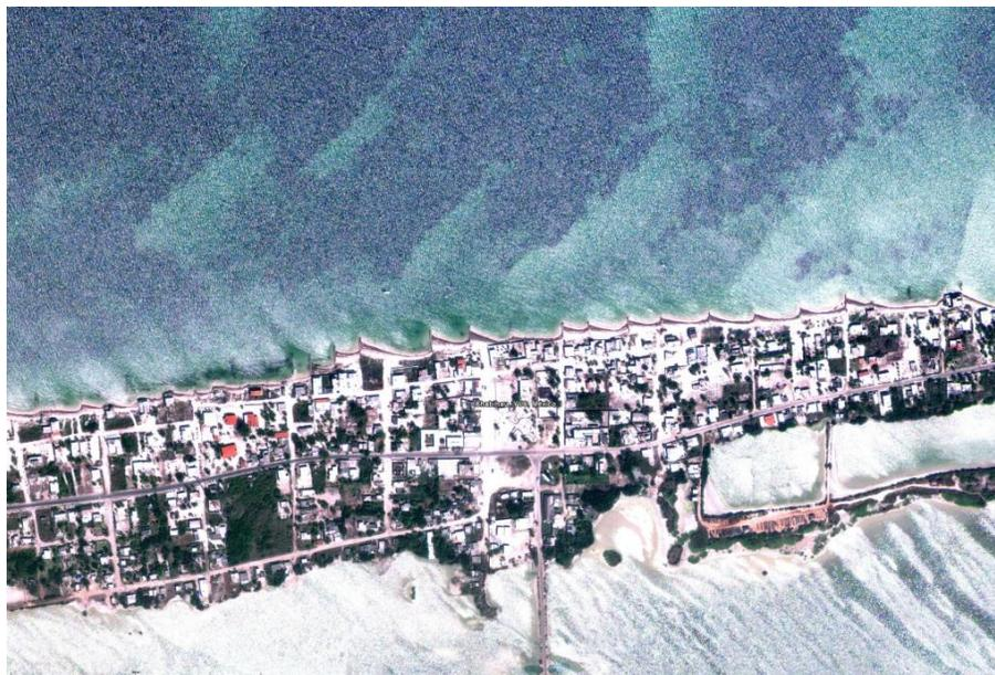
**Figura 246.** Vista panorámica de la problemática ocasionada por la erosión que causa en la zona costera los diques instalados de manera particular por los vecinos de Chabihau, produciendo daño al vecino inmediato, ya que el primero recupera playa y el segundo la pierde.
