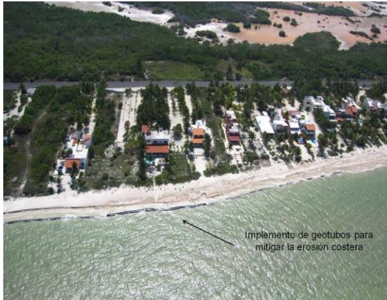
**Fotografía 141.** Implementación de geotubos como obras de mitigación contra la erosión costera en la localidad de Huaytum, municipio de Ixil.
