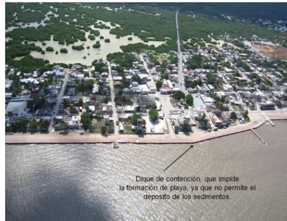
**Fotografía 136.** En la localidad de Dzilam de Bravo, el dique de contención, impide el depósito de sedimentos.
