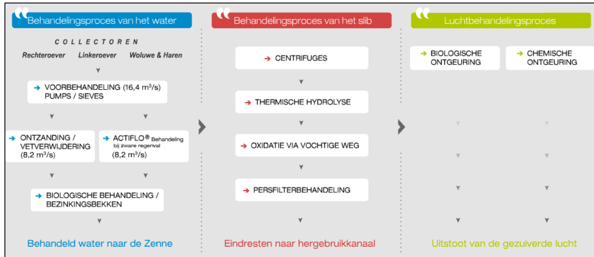
Figuur 11: Behandelingsproces Brussel Noord van water, slib en lucht (Bron: Aquiris)
